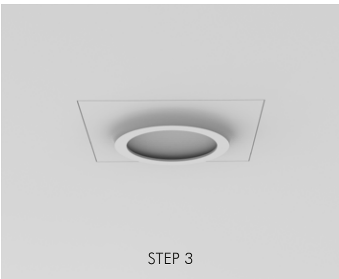
Produit positionné et fixé sur rails. Coupole positioned in cut-out and affixed to the rails.
