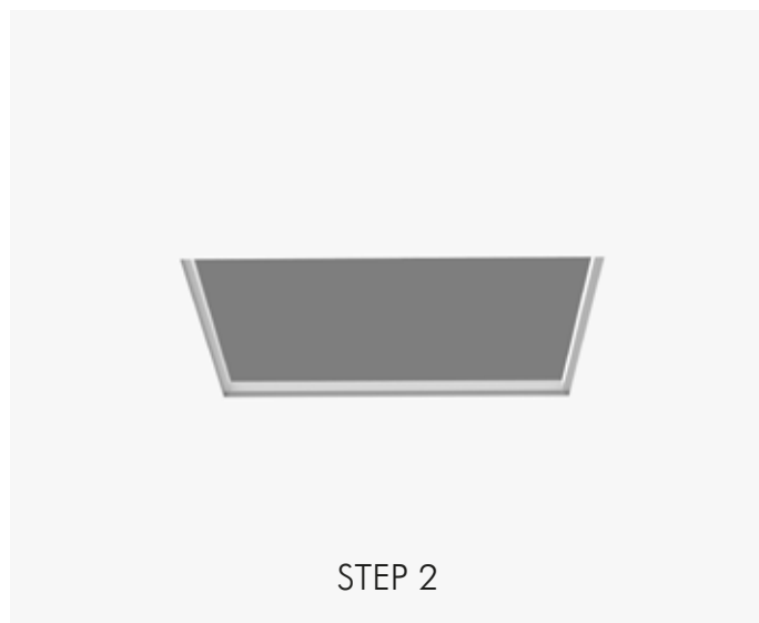
Découpe dans le plafond. Pose avec rails. Prepare the cut-out in the ceiling and position the fixing rails.
